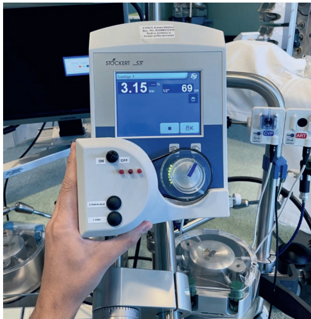
4.7.4 pav. Inovatyvus įrenginys, skirtas sugeneruoti stačiakampio formos bangas DKA metu
